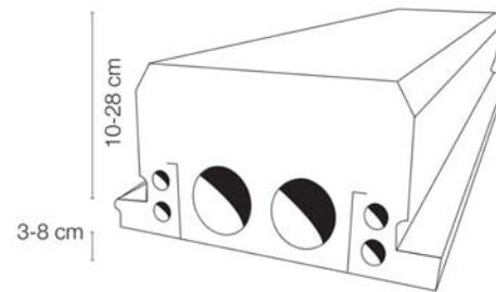
Amplitude da espessura da altura da viga (3-8 cm)
