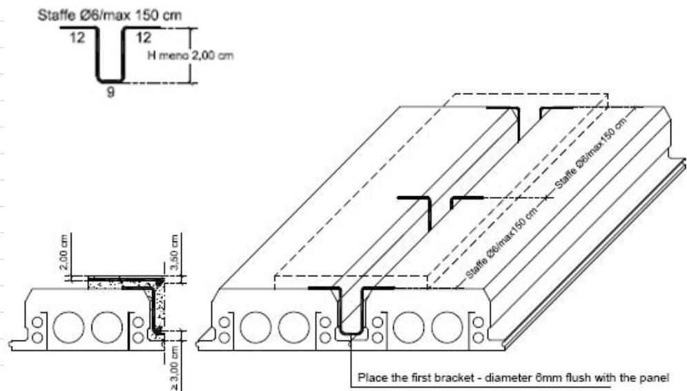
A trave de reforço superior das lajes deve ser colocada ao nível das colunas e fixada abaixo da grelha de aço eletrossoldada.
