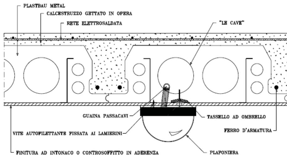
Encaixe para pendurar aparelhos de iluminação leves depois de o pavimento estar concluído, com um teto falso não aderente. Manga de ancoragem tipo chapéu de chuva fixada à placa de estuque, com fios elétricos dentro dos orifícios do Pavimento **Plastbau® Metal**: ver esquema abaixo.
