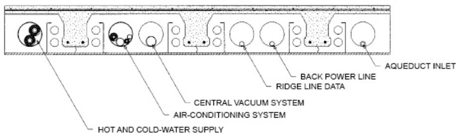
Além disso, é possível otimizar a espessura da laje já que as instalações podem ser efetuadas dentro dos orifícios longitudinais dos painéis, reduzindo ao mínimo a espessura intrados do pavimento. Ao encaixar os painéis através de juntas de caixa e espiga, é criada uma viga para sustentar as grelhas principais (retas, estacas e moldadas), a incluir na betonagem **Plastbau® Metal**, eliminando assim pontes térmicas.
